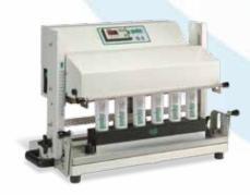
Импульсный запайщик для одновременной запайки и кодировки тубов.
